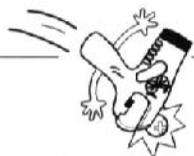
停電のときは、切替スイッチをOFF(切)にして、必ず電源プラグを持ってコンセントから抜いてください。電源が入ったままで通電が復帰すると、火災の原因になります。
